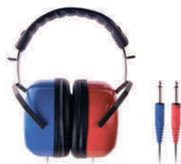
Аудиостимулятор (наушники аудиометрические изолированные) TDH-39
